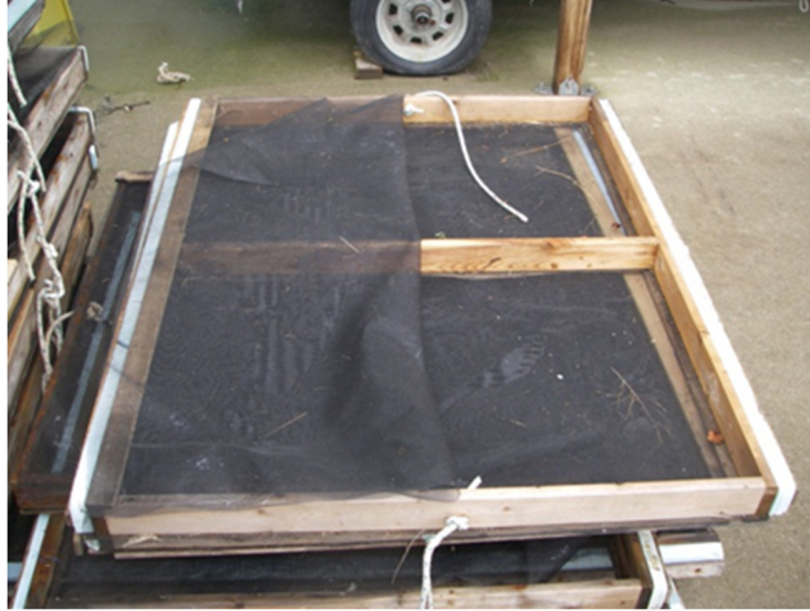
Photo 15. Plateau flottant utilisé au Maine pour le prégrossissement des myes.
