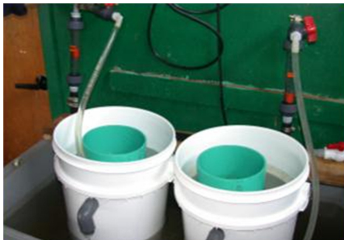
Photo 20. Upwellers expérimentaux de 15 cm de diamètre fabriqués avec des cylindres en PVC placés dans des chaudières.
