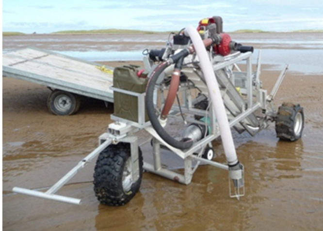
Photo 28. Prototype d'une récolteuse mécanisée pour la mye commune développée chez Merinov.
