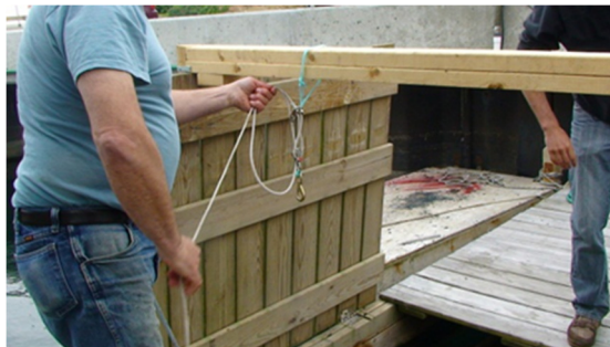
Photo 21. Potence utilisée à Martha's Vineyard (Massachusetts) pour soulever les silos de 0,23 m 3 (0,61 cm x 0,61 cm x 0,61 cm) du FLUPSY .
