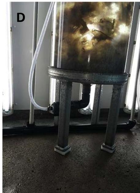
Figure 18. A. Bassins cylindriques utilisés pour le stockage des frondes de *P. umbilicalis*. B. Alimentation continue en eau de mer brute. C. Drain de surface avec grille. D. Injection d'air sous pression par le fond du bassin.
