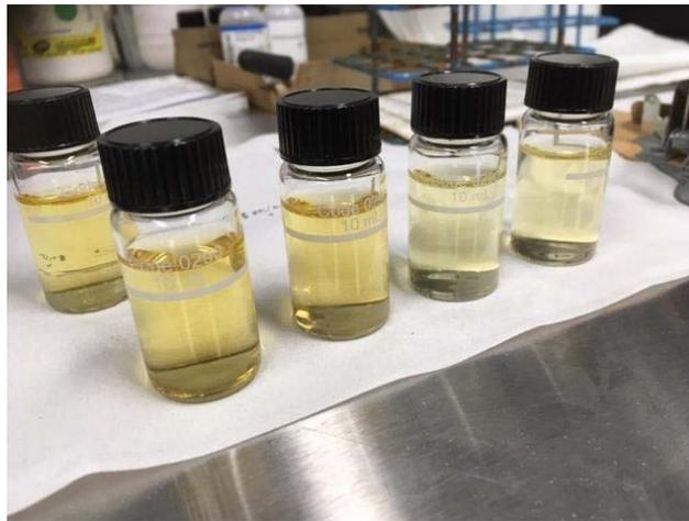
**Figure 24. Fioles utilisées dans les tests de colorimétrie pour déterminer la concentration de  $\text{NH}_4^+$  dans les systèmes de biofiltre d'algues.**
