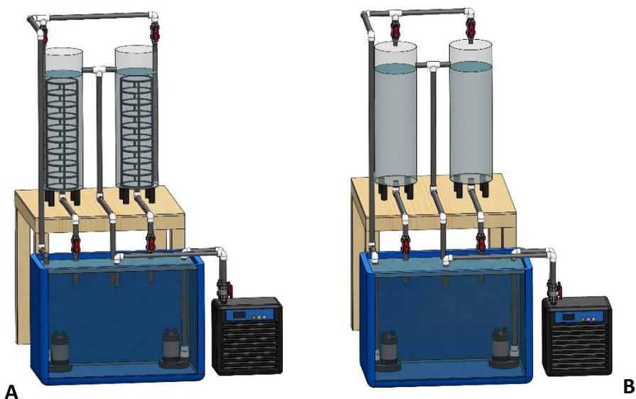
**Figure 23. A. Systèmes d’algues semi-immergées (biofiltre type percolateur). B. Système d’algues immergées (biofiltre immergé à lit dynamique).**
