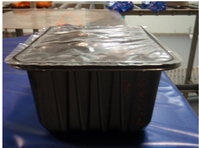
Photo 4 : Aspect de la barquette CAP dû à un manque d'étanchéité.
